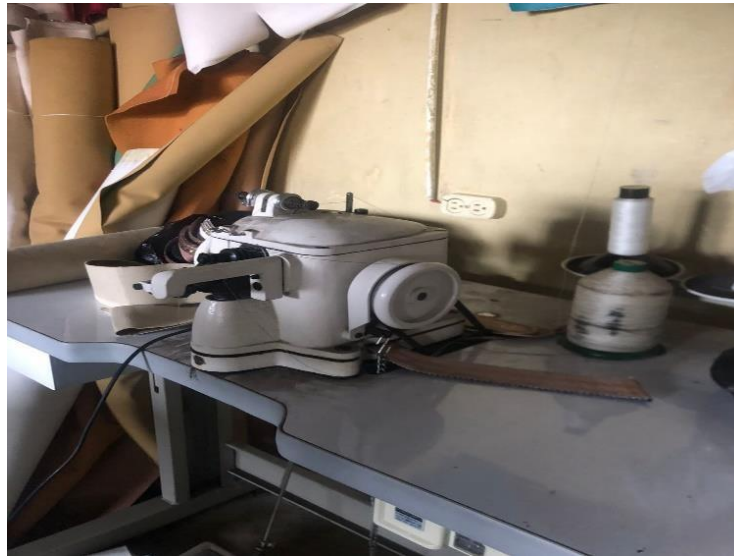
Figura 10. Ribeteadora de forro Fuente: Autor
