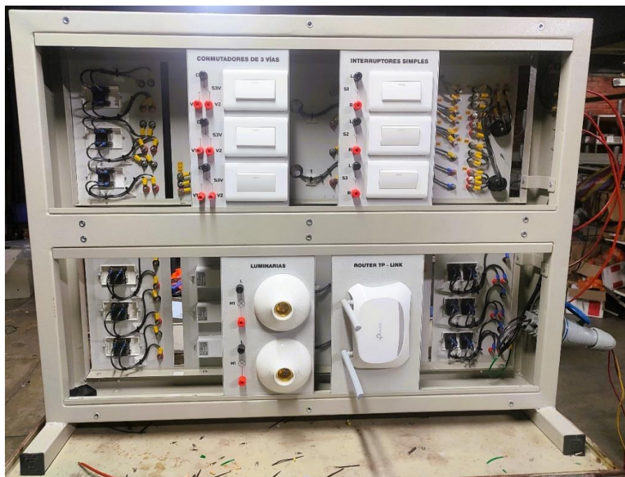
Figura 62. Cableado de láminas desmontables didácticas
