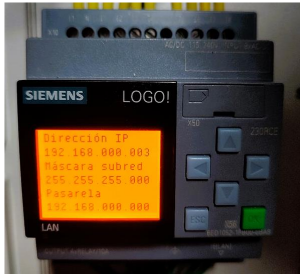
Figura 64. Configuración de la dirección IP en Mini PLC Logo
