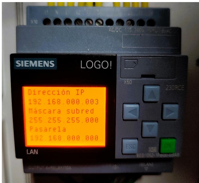
Figura 14. Identificación IP del controlador LOGO
