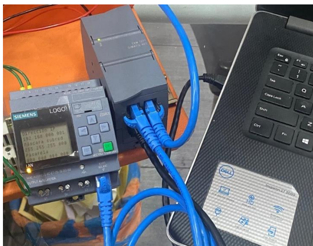
Figura 13. Comunicación Ethernet entre PLC Logo y PC
