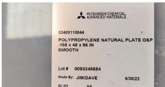
Figura 4-5.: Especificaciones de la plancha de polipropileno.
