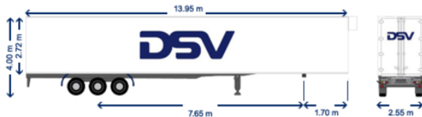
Figura 14. Dimensiones de camión estándar, [29].
