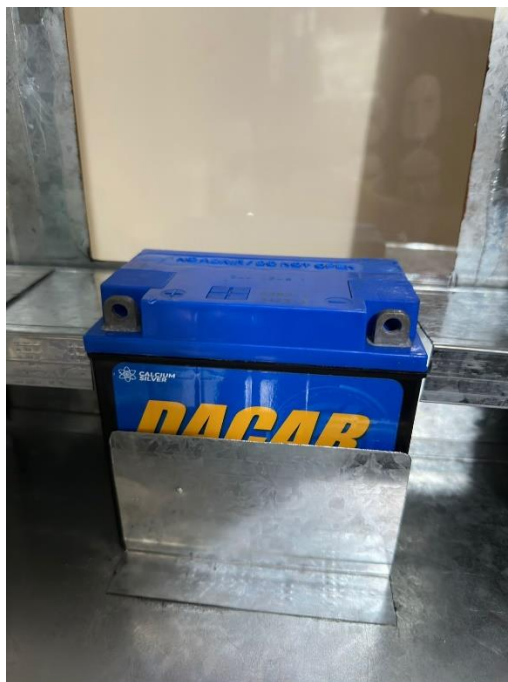
Figura 27 Batería de gel 12 V 9 Amp
