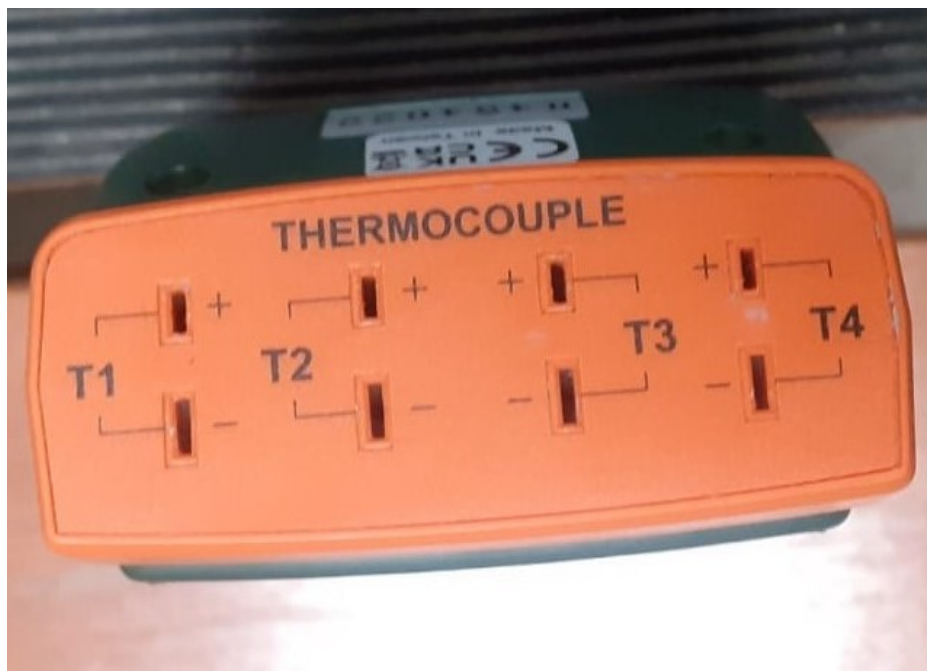
Figura 15: Entradas de los cuatro canales de conexión para los termopares del equipo Extech SDL200 [6]
