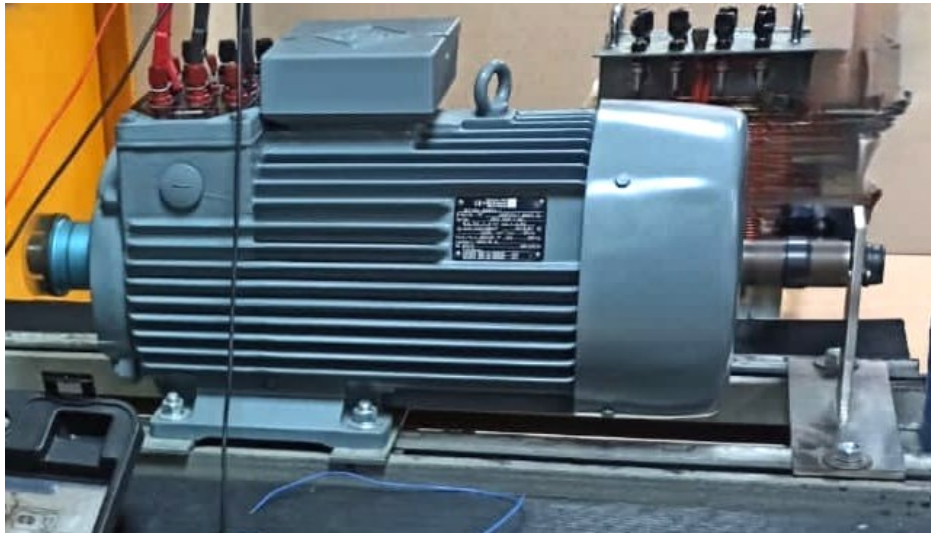
Figura 18: MI de rotor bobinado utilizada en el estudio
