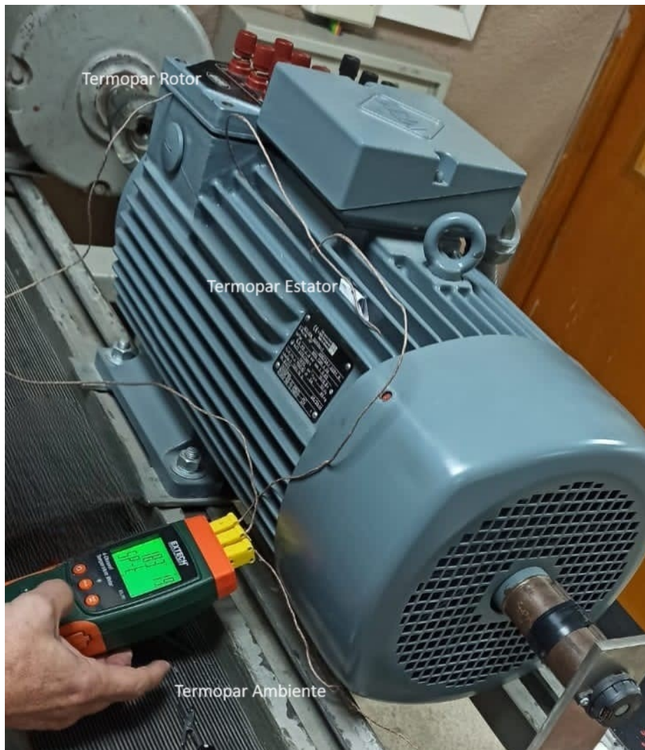
Figura 22: Termopares tipo K colocados en la MI de rotor bobinado
