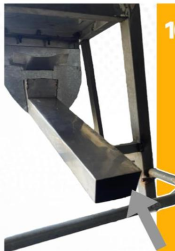
Conducto metálico por donde saldrá la quinua luego de completar el proceso de escarificación
