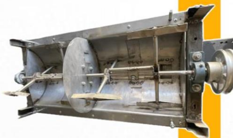
Parte interna del cilindro de la máquina donde por medio de dos filtros se escarifica la quinua.
