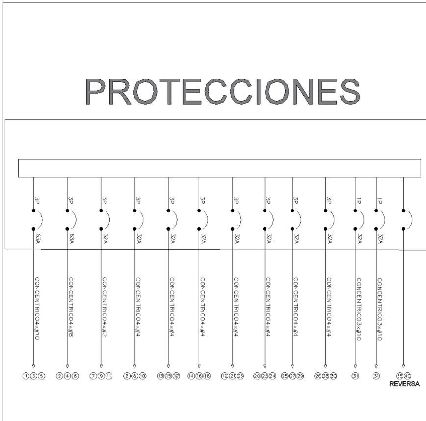
Figura 55. Subtablero Protecciones eléctricas
