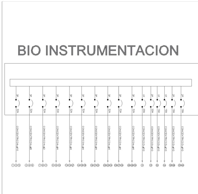
Figura 43. Subtablero Bioinstrumentacion Bloque E – Piso 2
