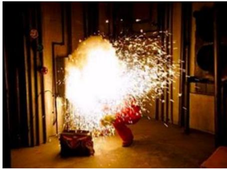
Figura 4. Riesgo por destello de arco eléctrico [3]
