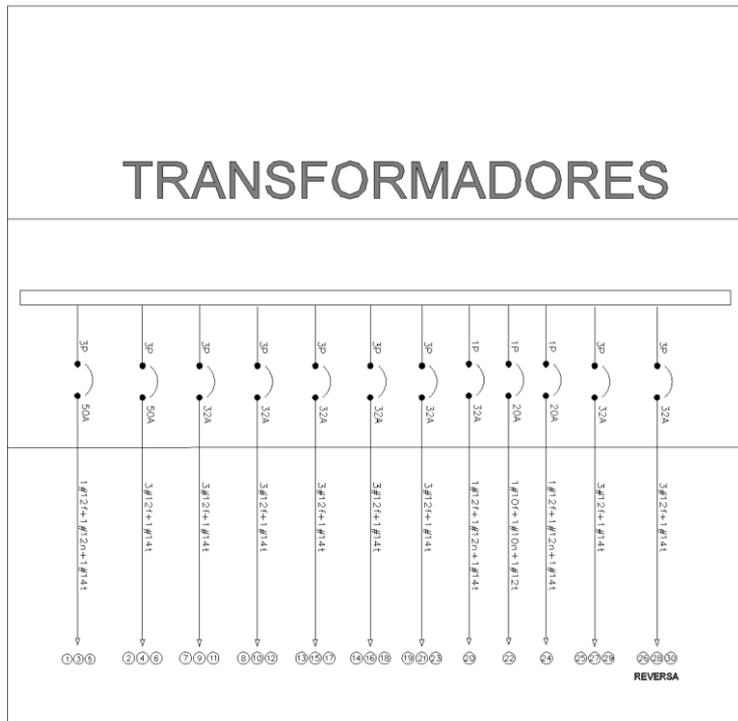
Figura 49. Subtablero de transformadores
