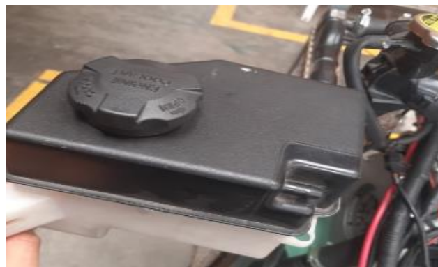
Figura 2.15 Depósito de refrigerante
