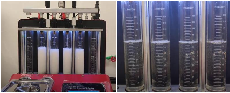
Figura 2.26 Volumen de combustible inyectado por cada inyector
