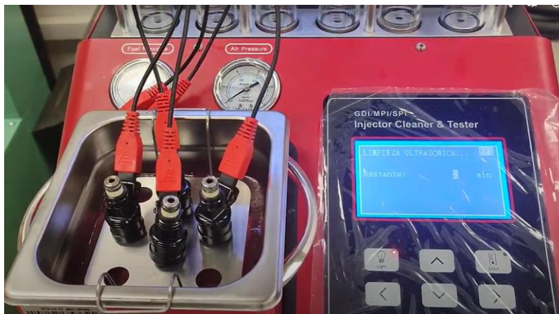
Figura 2.27 Limpieza de los inyectores
