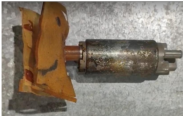
Figura 2.4 Bomba de combustible
