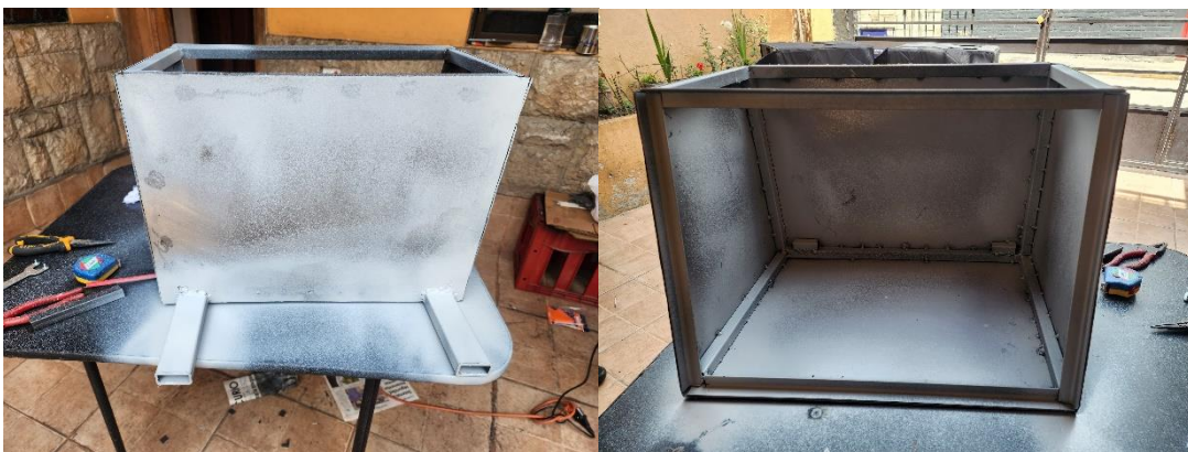
Figura 2.30 Construcción del tablero
