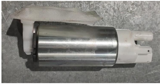
Figura 2.24 Bomba de combustible nueva
