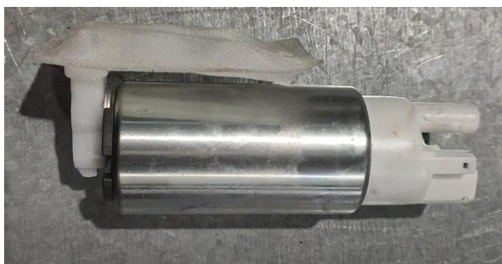
Figura 1.21 Electrobomba de combustible
