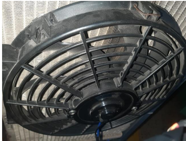
Figura 1.22 Constitución de un electroventilador
