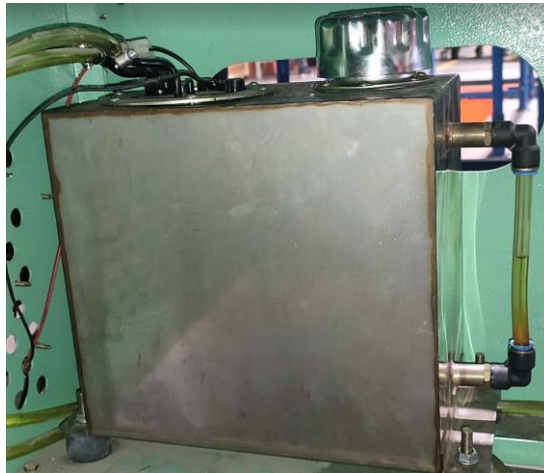
Figura 2.3 Tanque de combustible
