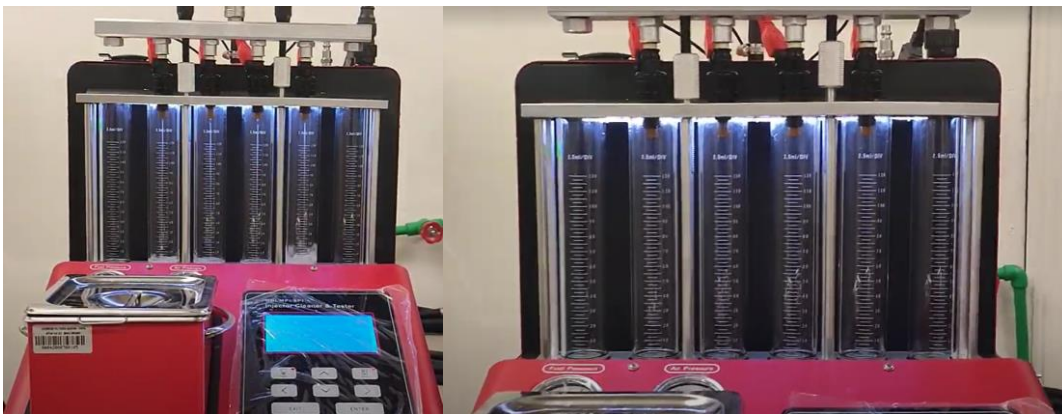
Figura 2.25 Prueba de fuga de los inyectores en el banco
