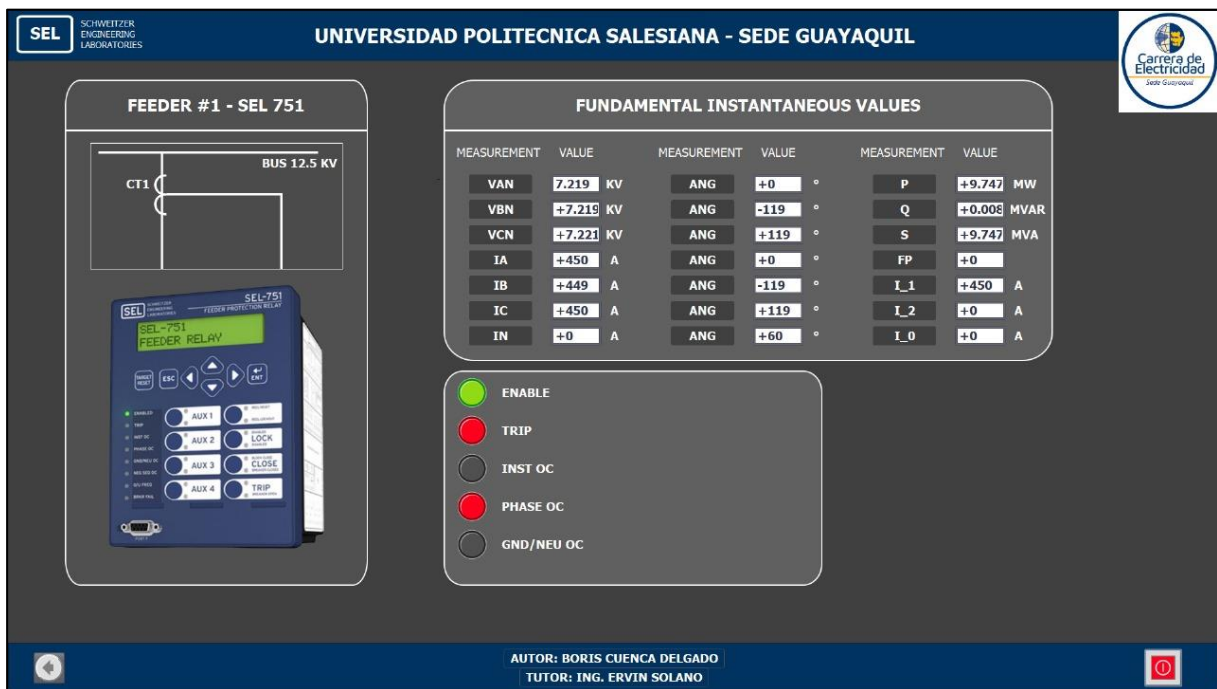
Figura 120.- Visualización SCADA falla Sobre corriente Fase SEL 751
