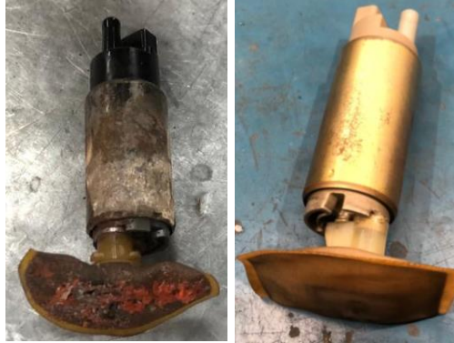
Figura 2.5: Bomba eléctrica de alimentación de combustible
