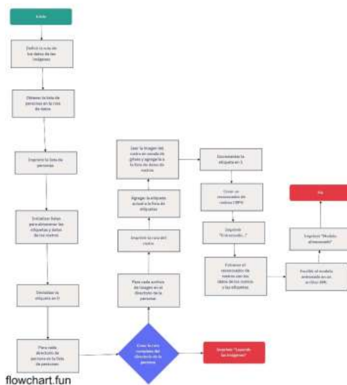
Figura 3.4.3 Diagrama de flujo del algoritmo implementado para la identificación Facial
