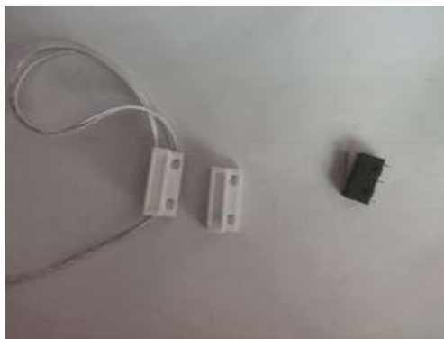
Figura 2.6.2 Sensor electromagnético y Switch Final de carrera
