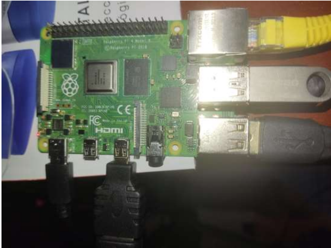
Anexo 4. Conexión Raspberry Pi 4
