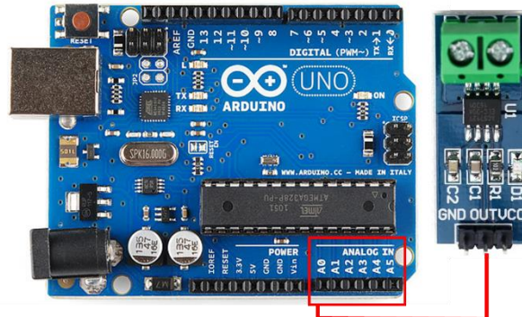
Figura 17. Conexión del pin OUT del módulo AC712 a Arduino Uno.
