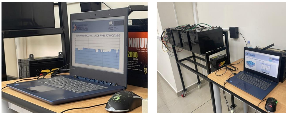
Figura 63. Sistema SCADA implementado mostrando los datos recopilados mediante una laptop.
