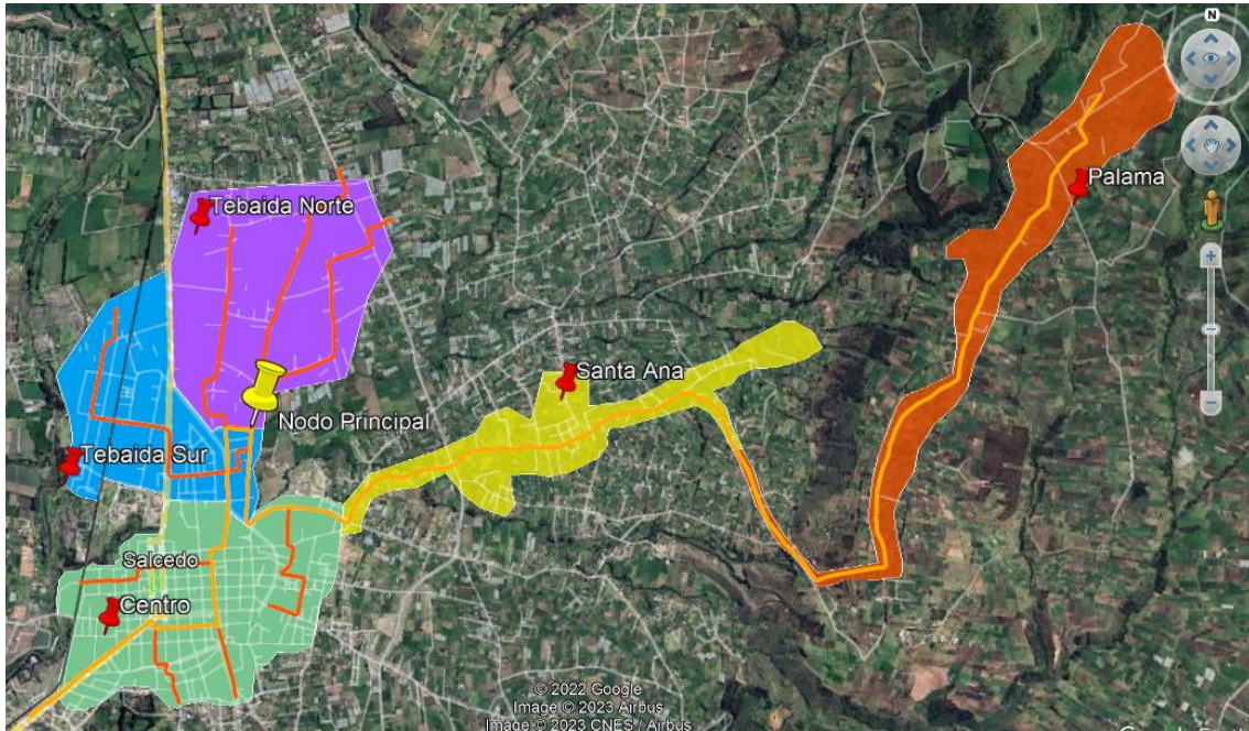
Ubicación geográfica del nodo, Fibra Óptica Troncal y Fibra Óptica dispersión o de segundo nivel de AJnet en la ciudad de Salcedo. Fuente: Cristian Carrillo.
