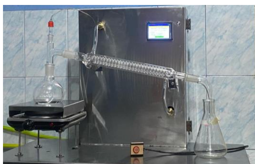
Figura 61. Destilador semiautomático de vodka.
