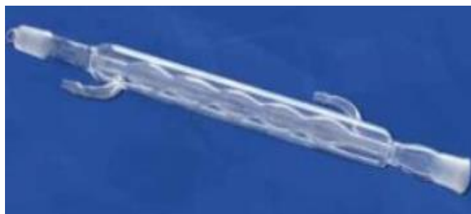
Figura 12. Tubo Condensador Allihn o Rosario. [20]
