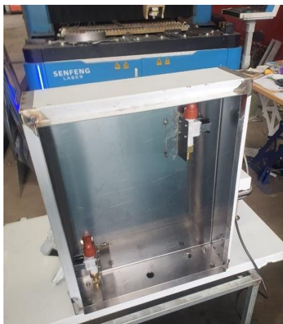
Figura 46. Colocación de soportes y electroválvulas.
