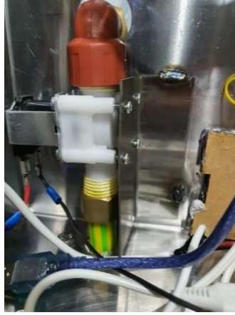
Figura 19. Conexión Válvula de salida.
