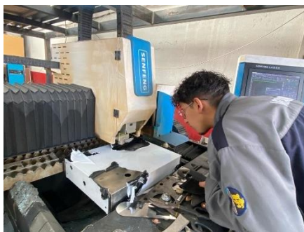
Figura 49. Corte de huecos para soporte de condensador.
