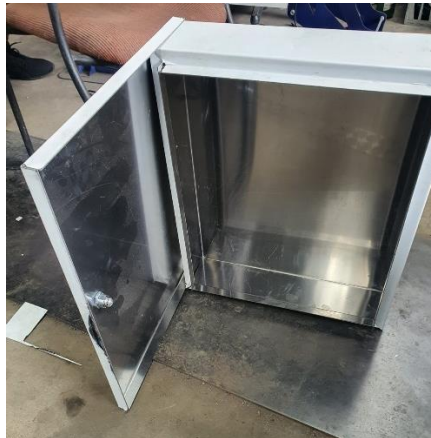
Figura 42. Armado del tablero de control.
