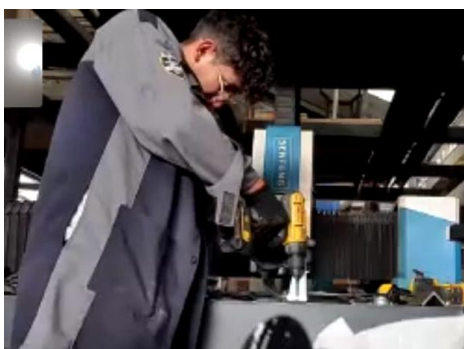
Figura 47. Perforación para soportes de electroválvulas.
