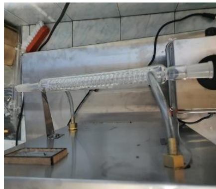
Figura 21. Conexión válvulas – condensador.
