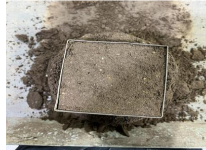
Figura 4. Tallado de la muestra de suelo del ensayo de Proctor Modificado para ensayo de Corte Directo.
