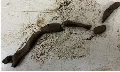
Figura 5. Ensayo del límite plástico rollo cuarteado.
