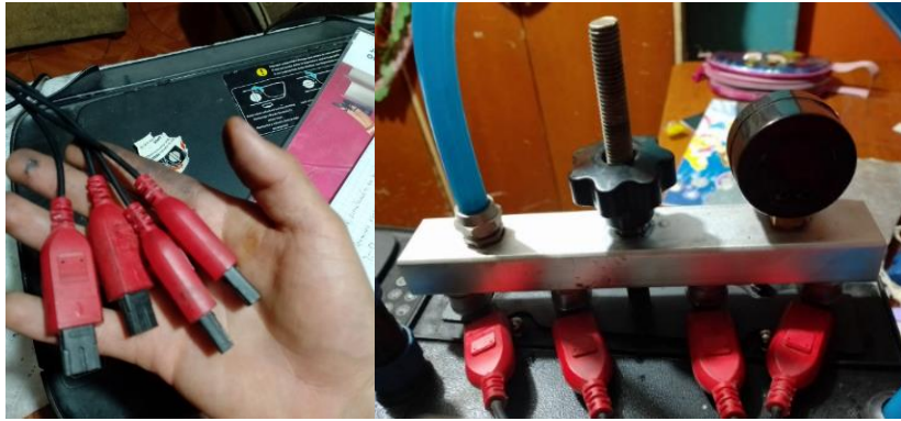
Figura 51. Conexión de los inyectores.
