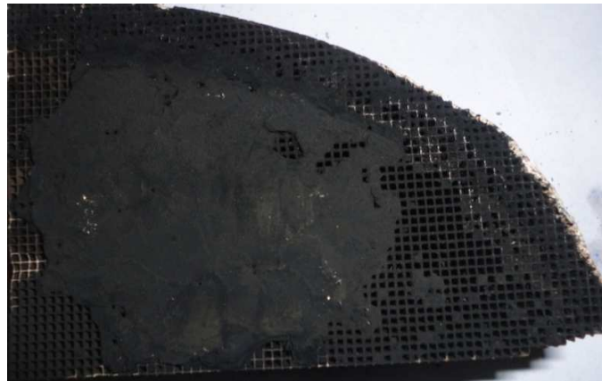
Fig. 4.12 Presencia de carbonilla en la entrada del catalizador Fuente: Autores
