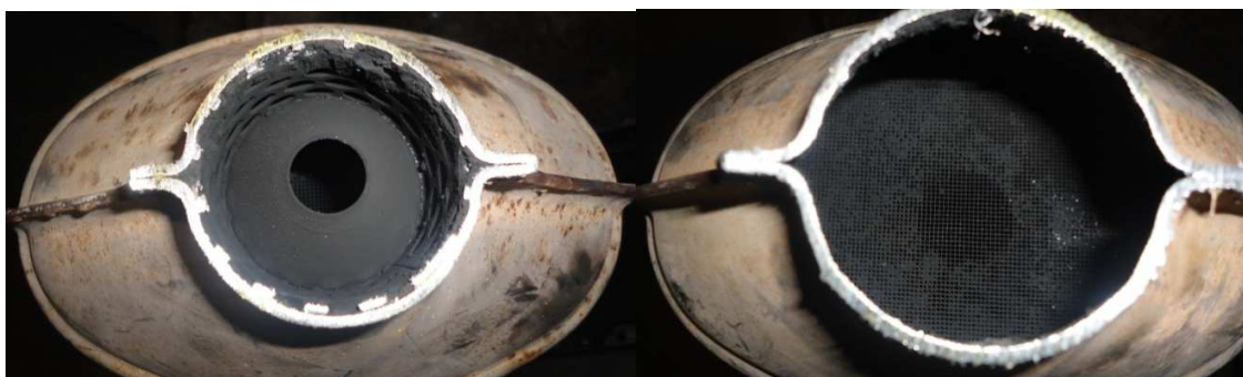
Fig. 4.5 Tobera de entrada y salida del catalizador oxidante Fuente: Autores
