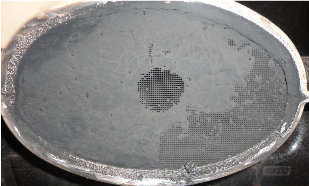
Fig. 4.7 Boca de entrada de los gases de escape al catalizador oxidante Fuente: Autores
