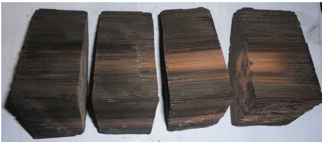
Fig. 4.11 Cortes del monolito cerámico cada 4.25 cm Fuente: Autores
