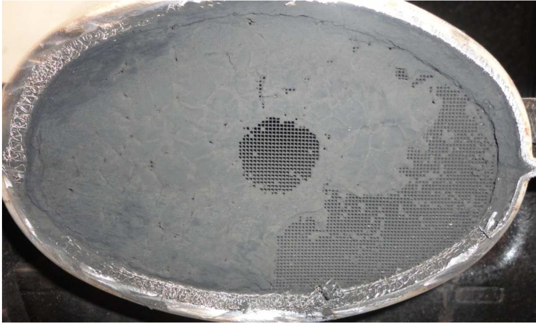
Figura 5.1 Taponamiento de la boca de entrada del catalizador oxidante Fuente: Autores
