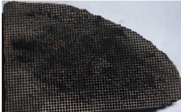
Fig. 4.14 Presencia de carbonilla a 8.5 cm de profundidad desde la entrada Fuente: Autores
