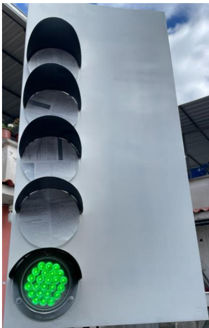
Fase 9: Prueba de funcionamiento de la matriz de Leds
