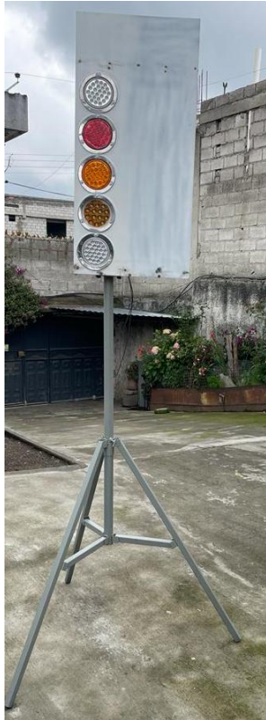
Fase 7: Ensamble del trípode con la estructura del solmáforo
