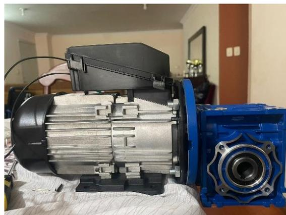
Figura 30. Motorreductor monofásico
