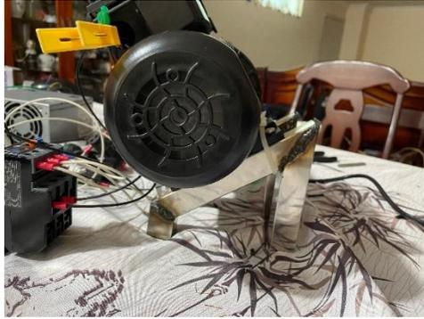
Figura 33. Estructura para elevar e inclinar el motor a 30°
