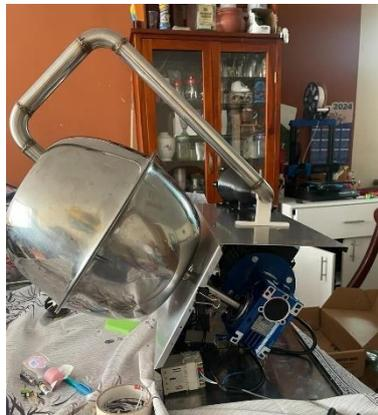
Figura 34. Ensamble de la botonera, motor y tubo de aire.
