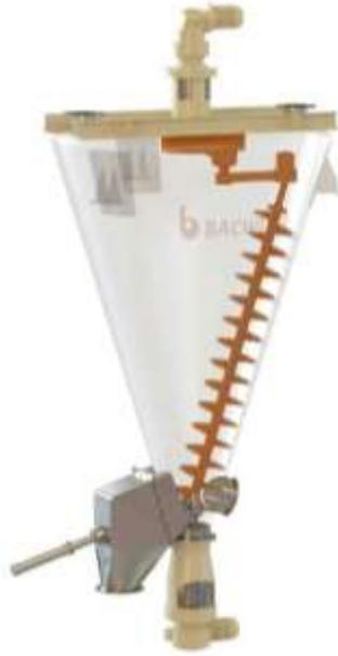
**Figura 10.** Mezcladora vertical[28].
