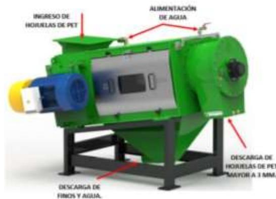
**Figura 5.** Lavadora centrífugadora [11].
