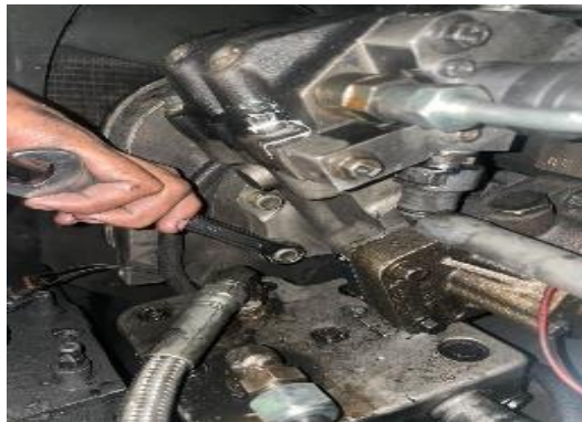
Figura 4.27: Retiro del soporte de la bomba
