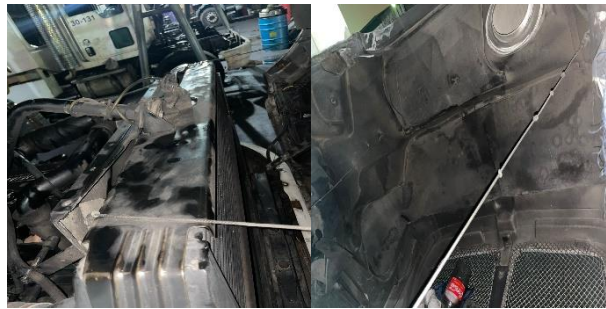
Figura 4.3: Cables de seguridad
