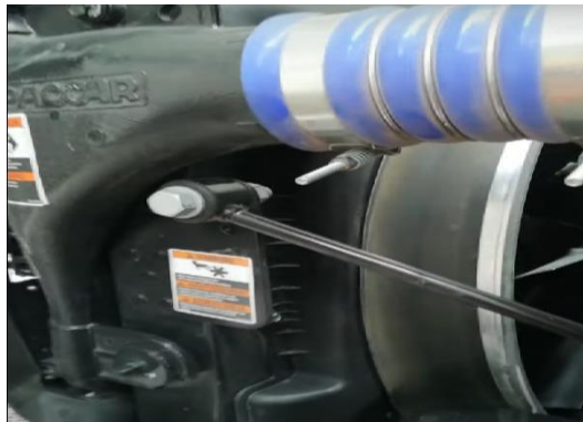
Figura 4.14: Mangueras conectadas al intercooler
