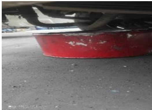
Figura 4.5: Drenaje del aceite de motor
