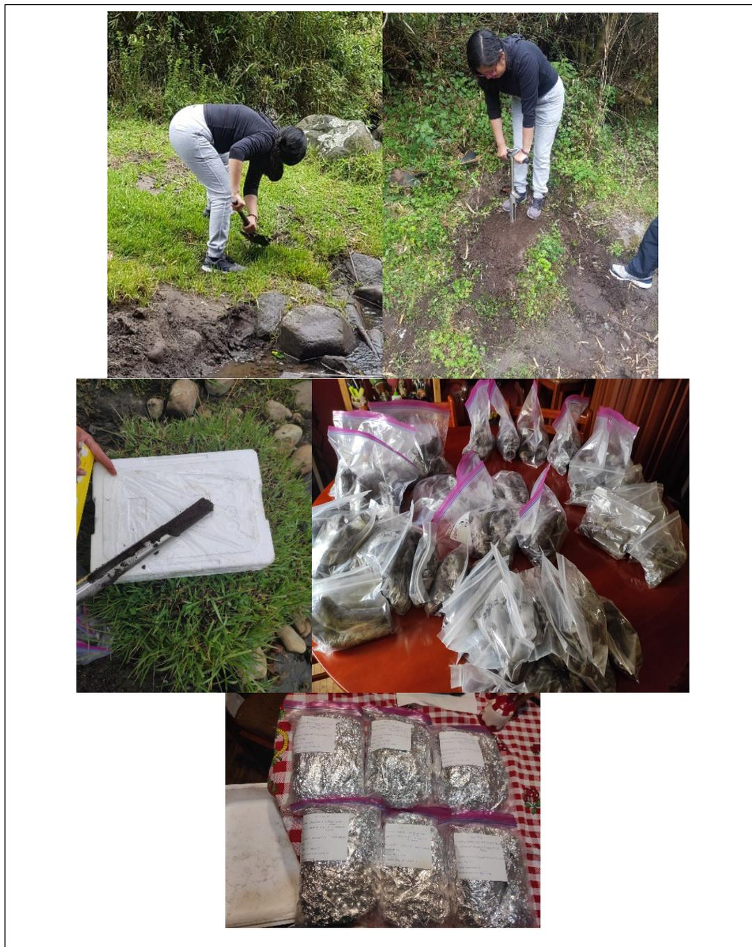
**Nota.** Fotografías de la toma de muestras con ayuda del barreno y etiquetado
