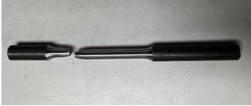
**Anexo 6.** Probeta después de la ruptura
