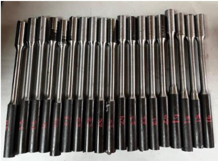
**Anexo 5.** Probetas de acero AISI 4340 mecanizadas
