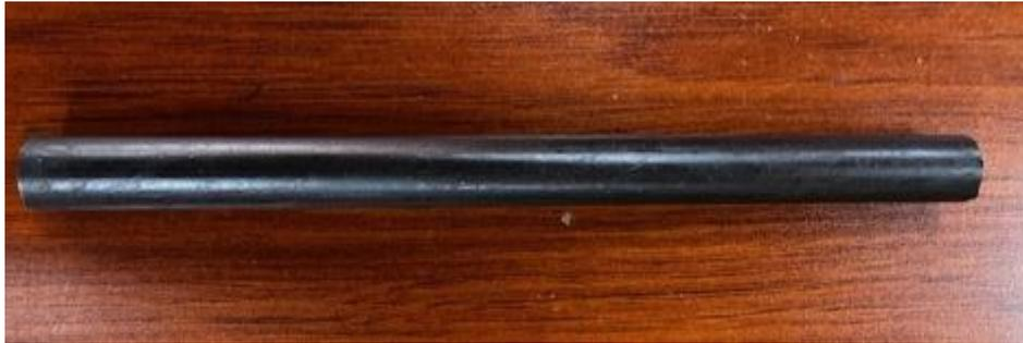
**Anexo 4.** Probeta acero AISI 4340
