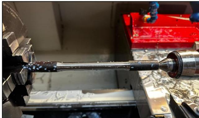
**Figura 12.** Maquinado de probeta
