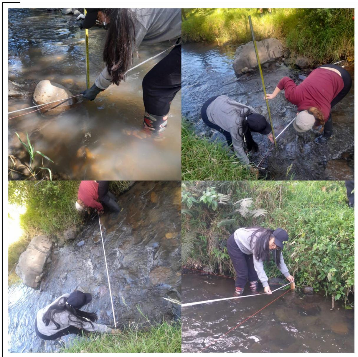
Nota. Presentación de método del flotador para aforo de caudal en planta de tratamiento de aguas residuales. Elaborado por: La autora.
