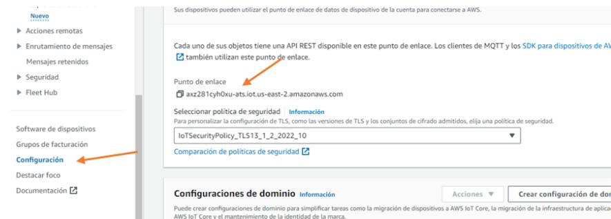
Figura 9: Selección del puerto de enlace para conexión segura con el ESP32 (AWS, 2024)
