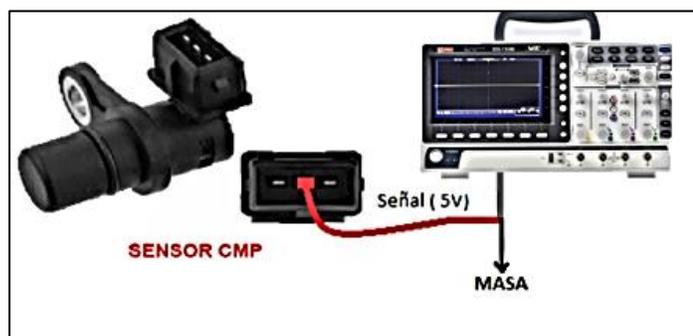
Imagen 7. Toma de señal del sensor CMP
