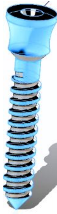
Figura A-2.: Nota. Modelado del cuerpo del implante dental en Solidworks
