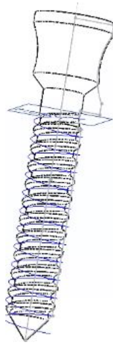
Figura A-4.: Nota. Modelado del cuerpo del implante dental en Solidworks
