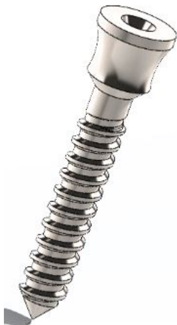
Figura 4-1.: Nota. Modelado del cuerpo del implante dental en Solidworks
