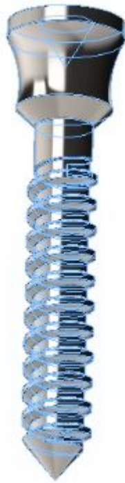
Figura A-1.: Nota. Modelado del cuerpo del implante dental en Solidworks
