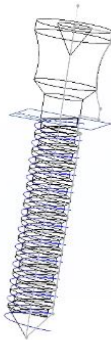
Figura A-5.: Nota. Modelado del cuerpo del implante dental en Solidworks
