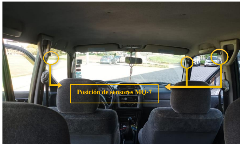
Figura 2. 13: Posición de los sensores MQ-7
