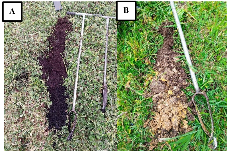
Ilustración 3. “Aspecto máximo y mínimo en el perfil del transecto 1”. A) Se extrajo una capa de suelo orgánico de 100 cm de profundidad mediante barrenación en el punto 27. B) Se extrajo una capa de suelo orgánico de 20 cm de profundidad mediante barrenación en el punto 22.
