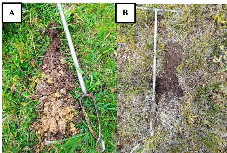
Ilustración 8. “Índice de humedad máxima y mínima en el perfil del transecto 1”. A) Se extrajo una capa de suelo orgánico de 20 cm de profundidad mediante barrenación en el punto 22. B) Se extrajo una capa de suelo orgánico de 25 cm de profundidad mediante barrenación en el punto 17.
