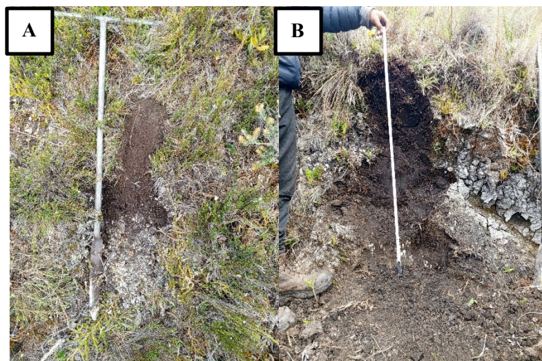
Ilustración 5. “Curvatura tangencial máxima y mínima en el perfil del transecto 1”. A) Se extrajo una capa de suelo orgánico de 25 cm de profundidad mediante barrenación en el punto 17. B) Se obtuvo una capa de suelo orgánico en el punto 7 de 55 cm de espesor utilizando la vía de acceso.
