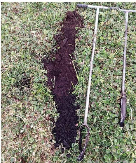
Figura: 2. Herramientas de excavación “barrenos” Fuente: Yanez, 2024.
