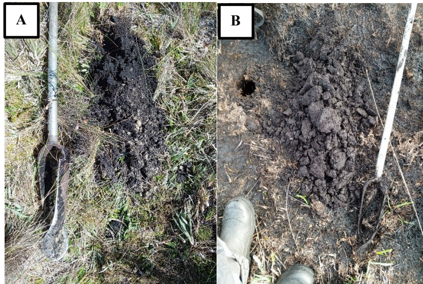
Ilustración 11. “Elevación máxima y mínima”. A) Elevación máxima con capa de suelo orgánico tipo “O+A” en el punto 151 de 35 cm mediante barrenaciones. B) Elevación mínima con capa de suelo orgánico tipo “O+A” en el punto 86 de 115 cm mediante barrenaciones.
