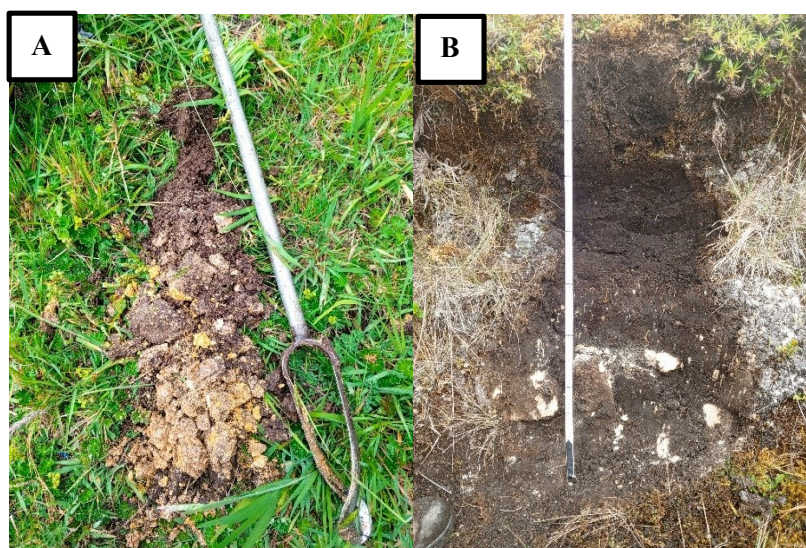
Ilustración 1. “Elevación máxima y mínima en el perfil del transecto 1”. A) Se extrajo una capa de suelo orgánico de 20 cm de profundidad mediante barrenación en el punto 22. B) Se obtuvo una capa de suelo orgánico en el punto 1 de 45 cm de espesor utilizando la vía de acceso.
