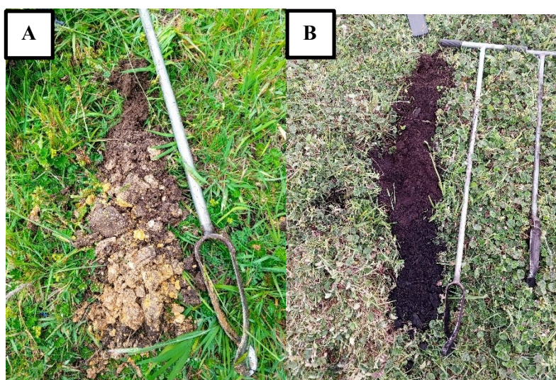
Ilustración 4. “Descripción de curvatura máxima y mínima en el perfil del transecto 1”. A) Se extrajo una capa de suelo orgánico de 20 cm de profundidad mediante barrenación en el punto 22. B) Se extrajo una capa de suelo orgánico de 100 cm de profundidad mediante barrenación en el punto 27.
