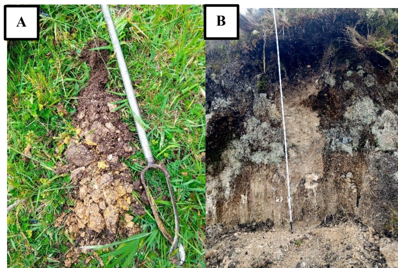
Ilustración 2. “Pendiente máxima y mínima en el perfil del transecto 1”. A) Se extrajo una capa de suelo orgánico de 20 cm de profundidad mediante barrenación en el punto 22. B) Se obtuvo una capa de suelo orgánico en el punto 10 de 40 cm de espesor utilizando la vía de acceso.
