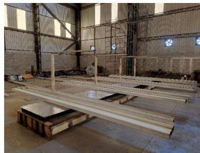
Figura 10. Perfiles que son usados como sobre carga para los ensayos.
