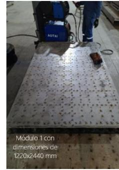
**Figura 4a.** Módulo fabricado de 1220 x 2440 mm.
