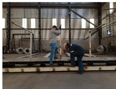
Figura 11. Preparación para el control de deflexiones.
