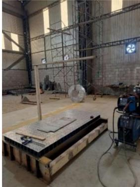
**Figura 6.** Módulo del diafragma apoyado en sus extremos listo para ensayar.
