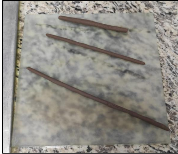
Figura 13 – Ensayo de “lombrices” de 3mm.
