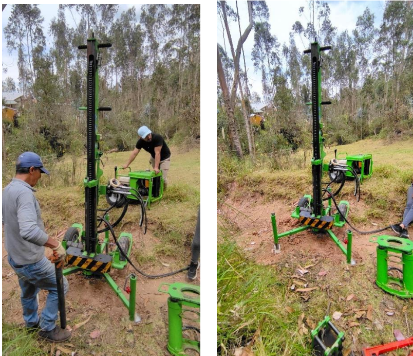
Anexo 3 - Ensayo de campo, toma de muestras con SPT Estribo B.
