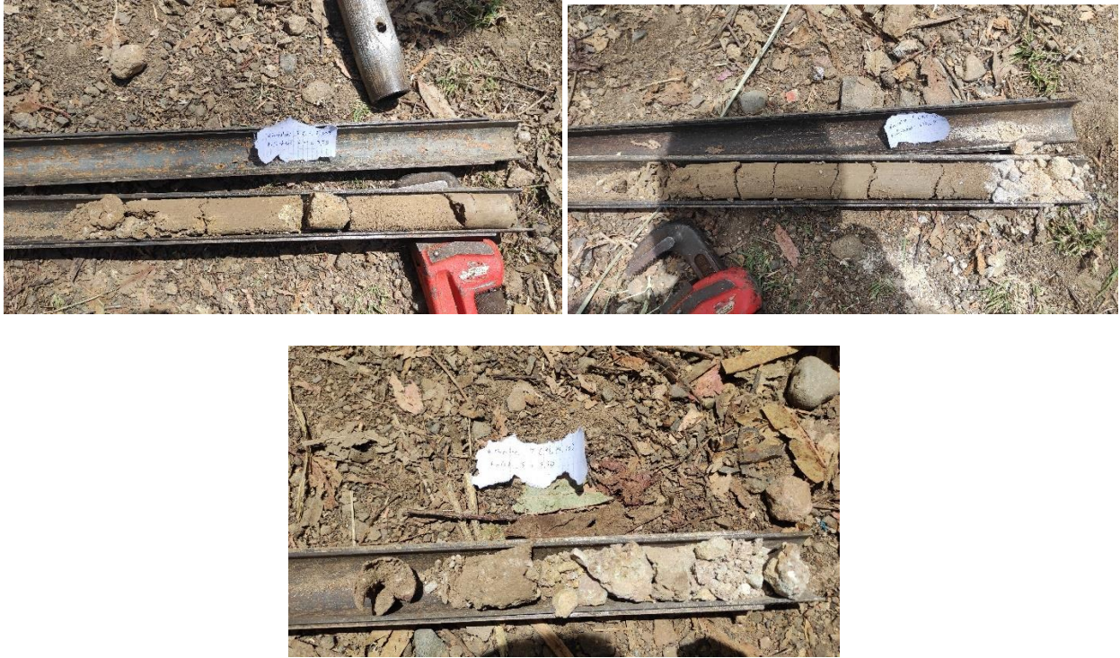
Anexo 3 - Ensayo de campo, toma de muestras con SPT Estribo B.
