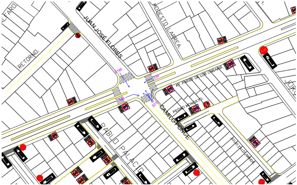
Ilustración 74. Plano vista planta señalización y giros.
