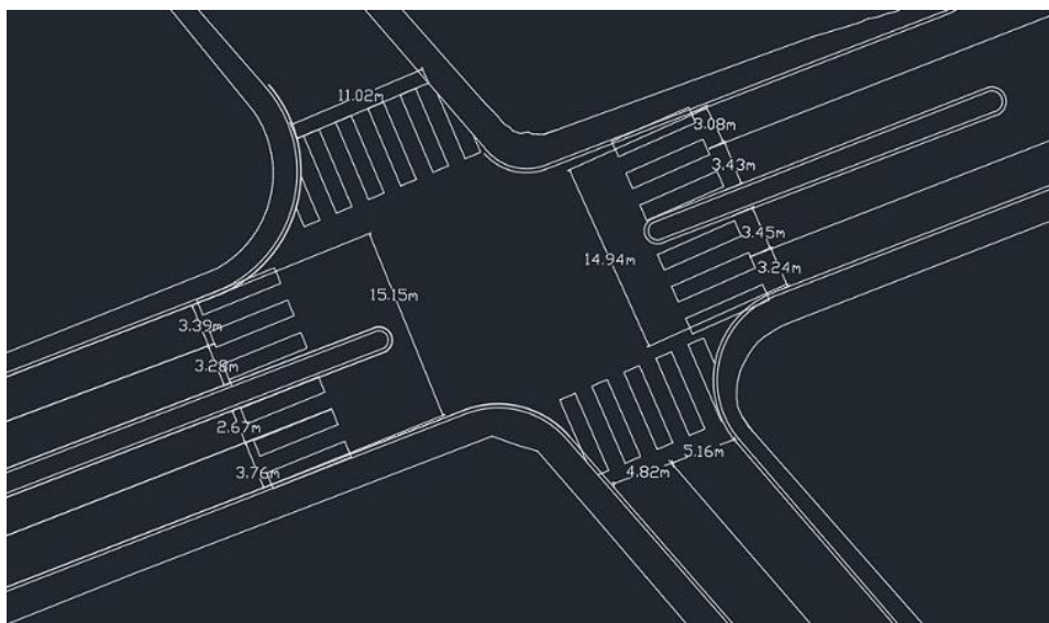
Ilustración 19. Condiciones geométricas de la intersección
