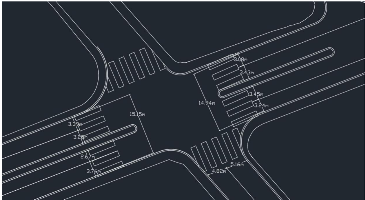
Ilustración 75. Plano trazado calzada, vereda, bordillo y medidas.
