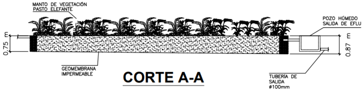
Figura 14: Humedal artificial subsuperficial horizontal en corte A-A
