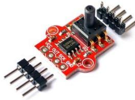
Fig. 16. Módulo Sensor de presión HX710B (BIGTRONICA, 2023)
