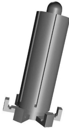
*Fig. 29. Molde de la sonda: componente macho (Autor)*
