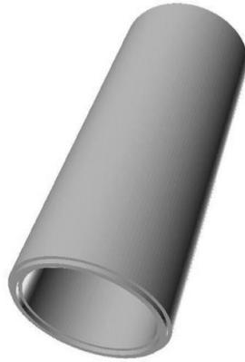
*Fig. 28. Molde de la sonda: componente hembra (Autor)*
