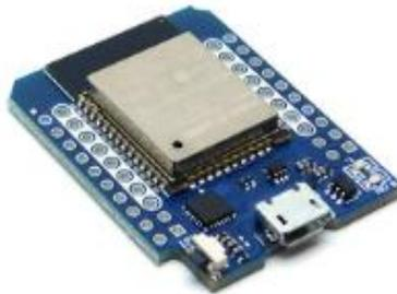
Fig. 18. Mini ESP32 (MACTRÓNICA, sf)
