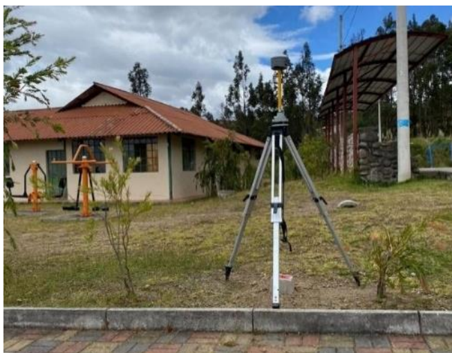
Figura 40. Planteo del RTK
