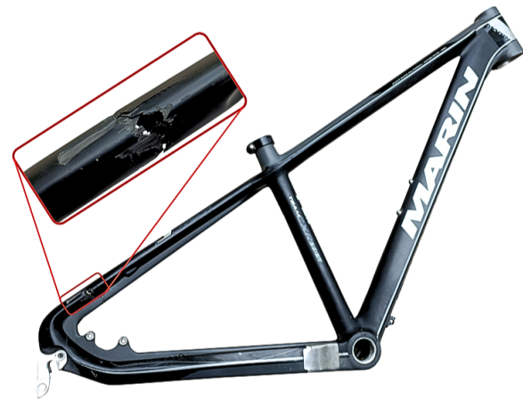
Figura 1. Falla en vainas superiores
