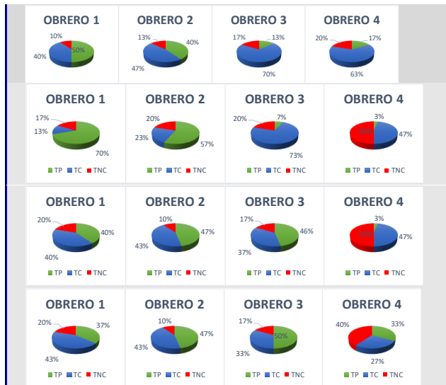
Figura 27. TP-TC-TNC actividad hormigonado pilotes/obrero-muestreo 1-2-3-4.
