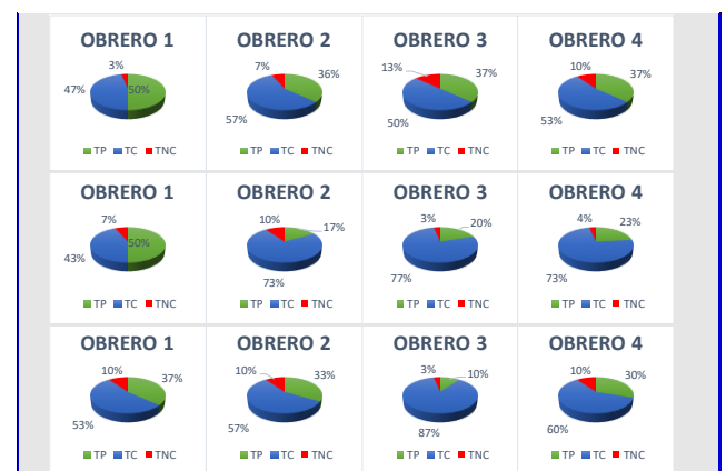
Figura 24. TP-TC-T-NC actividad encofrado para pilotes/obrero-muestreo 1-2-3-.
