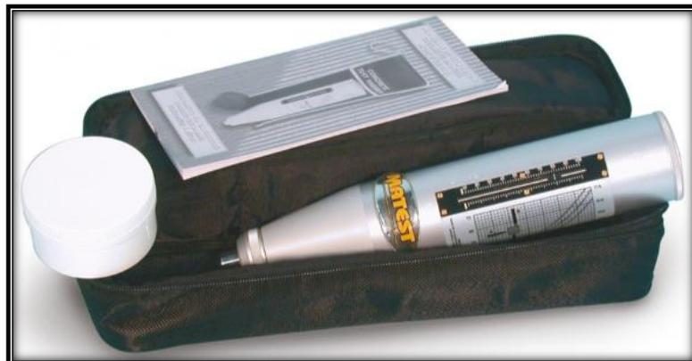
*Nota.* En la imagen se puede observar el esclerómetro que fue utilizado para los ensayos correspondientes en la superestructura del 'Bloque A'. Fuente: (Matest 2023).
