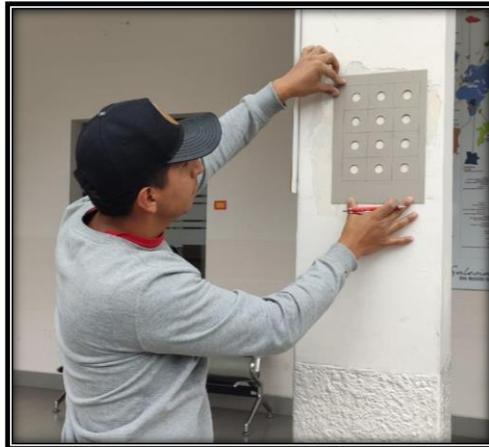
*Nota.* En la imagen se puede observar que se está definiendo el área de ensayo en un elemento estructural tipo columna con la plantilla, misma que permite ejecutar 12 golpes sobre la superficie escogida. Fuente: Los Autores.
