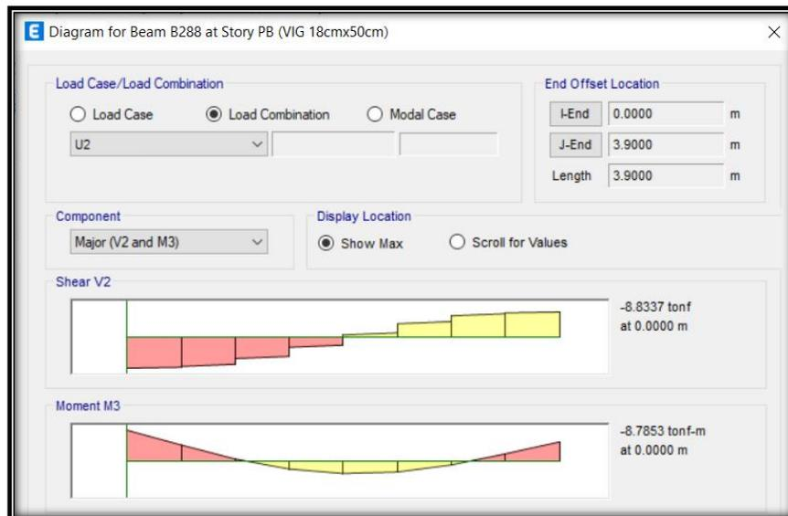
*Nota.* En la imagen se puede apreciar el momento máximo en la viga de 18cm x 50cm que se encuentra en la planta baja. Fuente: Los Autores a través de Etabs (2023).
