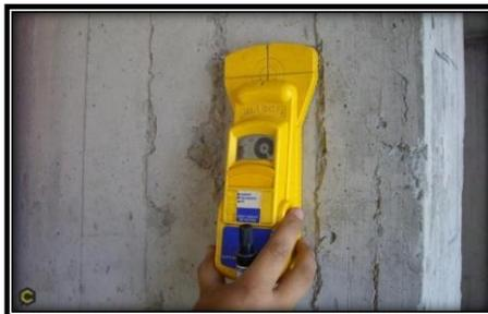
*Nota.* Detección de acero de refuerzo de un elemento estructural de hormigón armado. Fuente: Construyored (2021).
