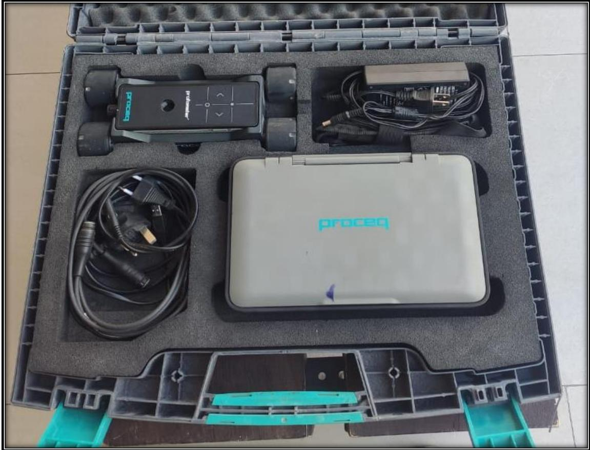
*Nota.* En la imagen se aprecia el pachómetro utilizado para detectar las barras de acero refuerzo dentro de las columnas, vigas y losas. Fuente: Los Autores.
