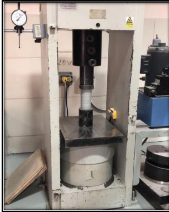
*Nota.* En la imagen se puede apreciar el ensayo de resistencia a la compresión en la maquina universal. Elaborado por: Los autores.
