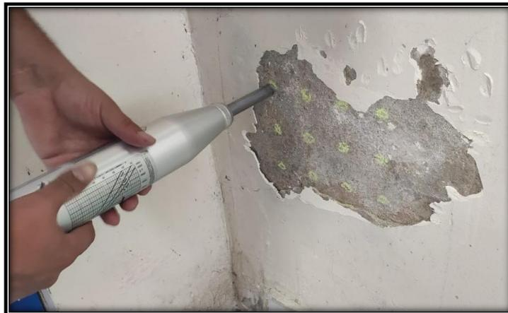
*Nota.* En la imagen se puede observar la superficie de ensayo libre de recubrimientos lista para ejecutar los golpes con el esclerómetro, a su vez, delimitada previamente con la plantilla. Fuente: Los Autores.
