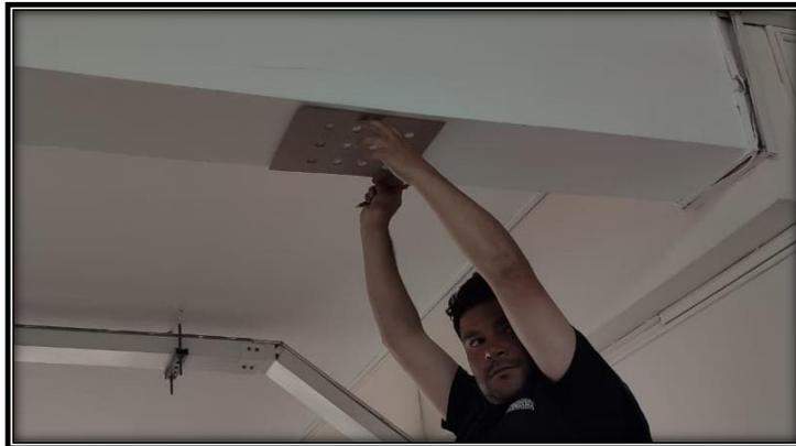
*Nota.* En la imagen se observa el área de ensayo delimitada por una plantilla que posee 12 orificios separados 4 cm entre cada uno de ellos. Fuente: Los Autores.
