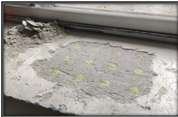
*Nota.* En la imagen se observa la superficie limpia, misma que se encuentra sin recubrimientos y con 12 marcas que nos permiten analizar toda el área de interés. Fuente: Los Autores.
