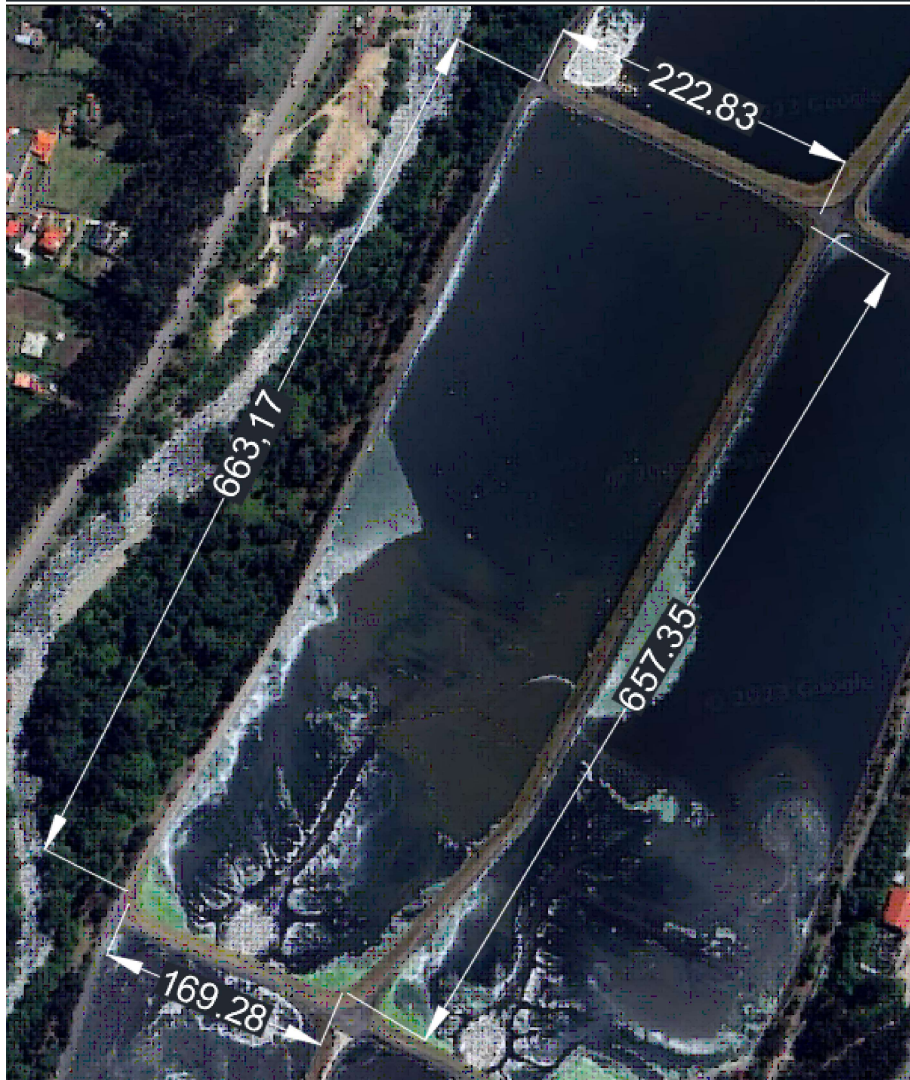
Figura 3.8: Dimensiones laterales de la laguna facultativa 1 [12].
