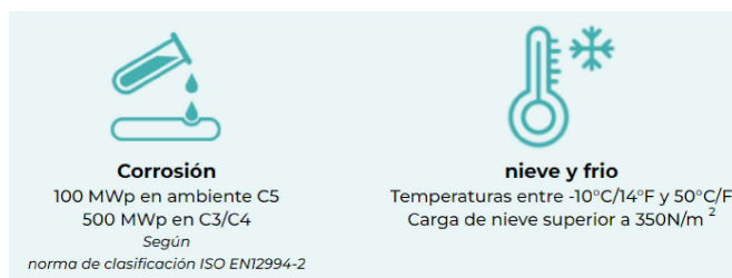
Figura 2.10: Cargas ambientales: corrosión y climas extremos que soporta la estructura de Ciel et Terre [8].
