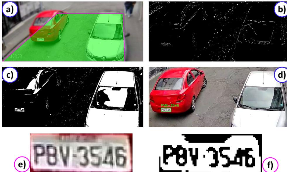
**Fig. 3.** a) Zona de trabajo remarcada en verde para la detección de placas. b) Transformada de Wavelet. c) Imagen reconstruida a partir de la aplicación de la transformada de Wavelet. d) Detección de la placa. e) Segmentación de la región de interés de la placa. f) Binarización de la sección de interés para transformar imagen a texto utilizando Tesseract.
