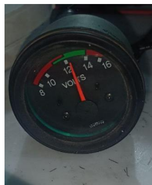
Figura 6. Medidor de voltaje de la batería.
