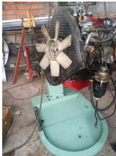
Figura 16. Aseguración del motor Diésel con un polipasto.
