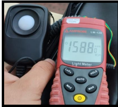
Figura 129. Valor de la primera medición en el exterior del Bloque B de día.
