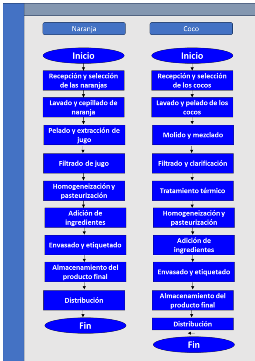
Figura 9: Diagrama de flujo del proceso de producción de jugo
