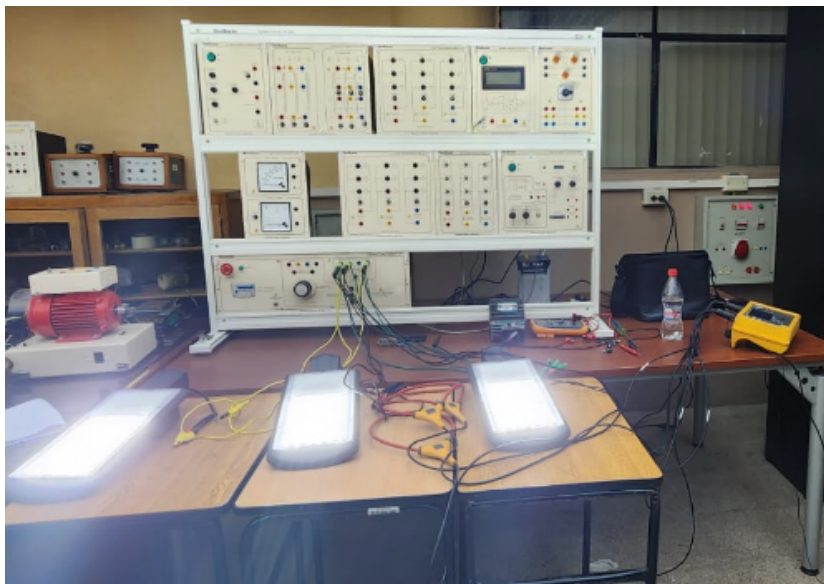
Figura 4.4: Comprobación de encendido Luminaria Marca 2 de 100W [Fuente: Autores.]
