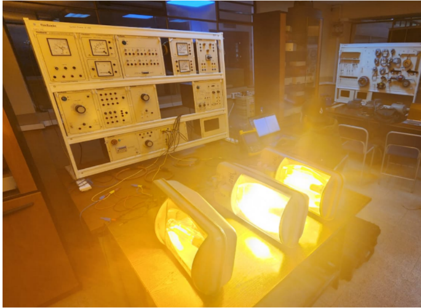
Figura 4.3: Comprobación de encendido Luminaria Marca 1 de 150W [Fuente: Autores.]
