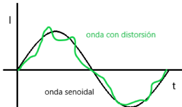
Figura 2.3: Ejemplo forma de onda con distorsión. [Autores]
