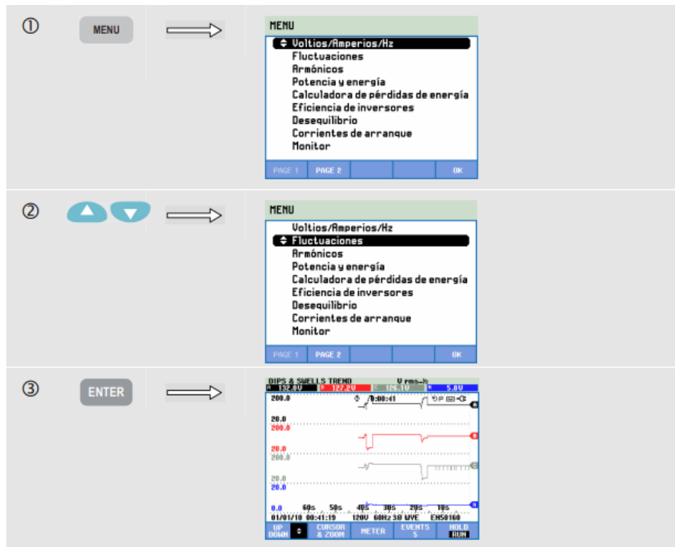
Figura 3.7: Pasos para medir Fluctuaciones en el equipo. Fuente: Manual Fluke 435 II . [34]
