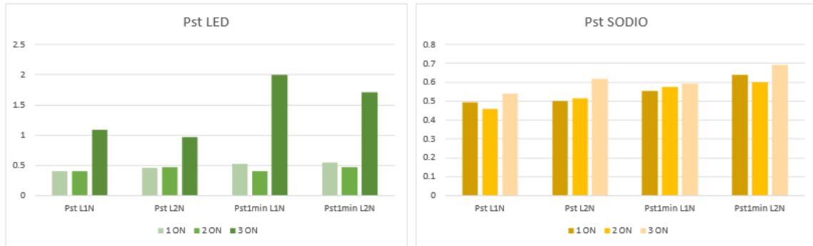
Figura 4.17: Diferencia severidad de flicker en luminaria sodio-LED con fuente fija en 3 casos de encendido.
