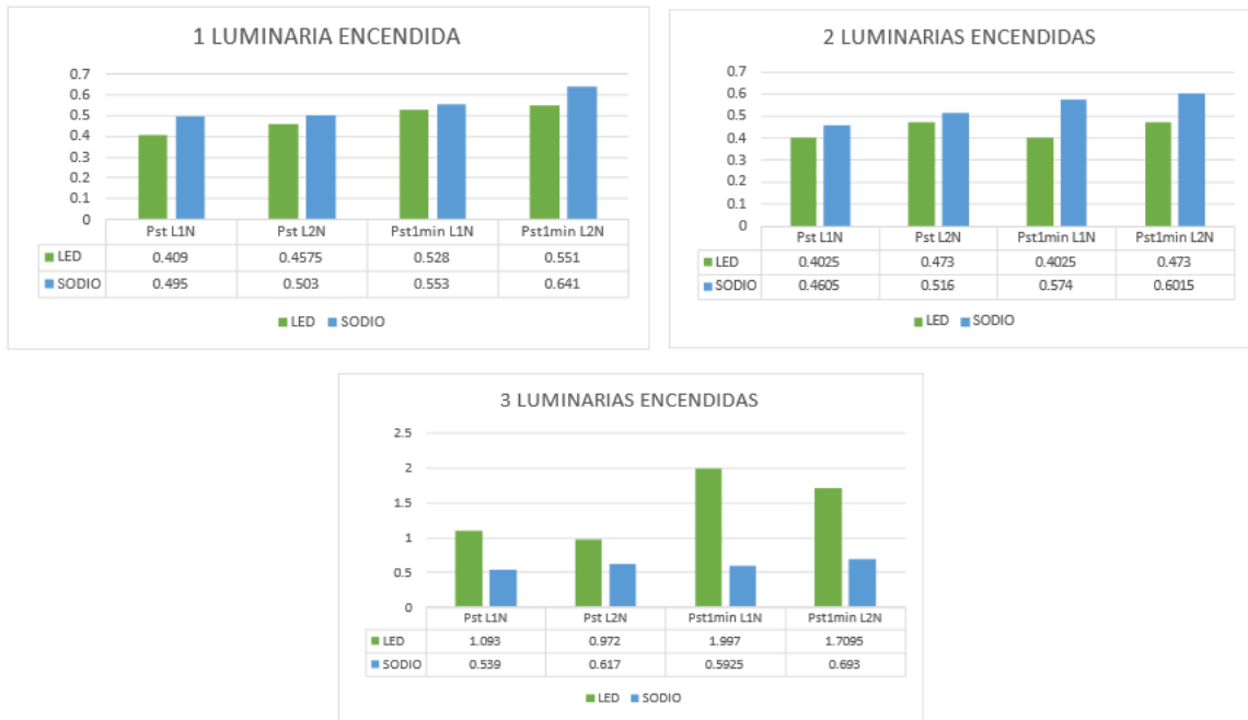
Figura 4.18: Diferencia severidad de flicker en luminaria sodio-LED con fuente fija.
