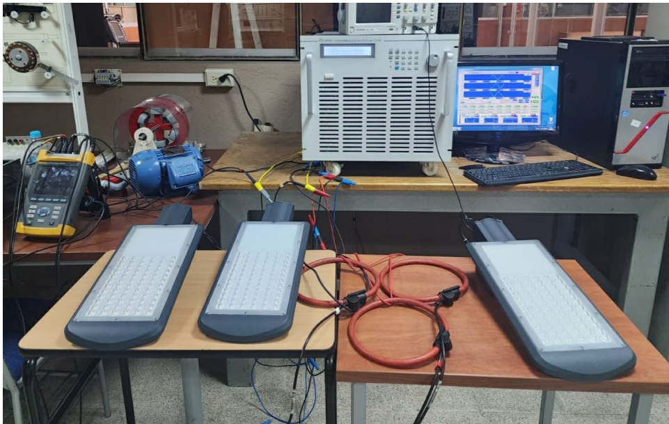
Figura 3.4: Medición de armónicos con fuente variable AC [Fuente: Autores]
