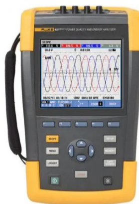
Figura 2.9: Analizador de redes trifásico FLUKE 435 Fuente: Manual Fluke 435-II [34]
