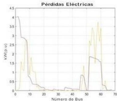
Figura 4. Comparación de pérdidas eléctricas del caso base y después de la reconfiguración en el caso de 69 barras.
