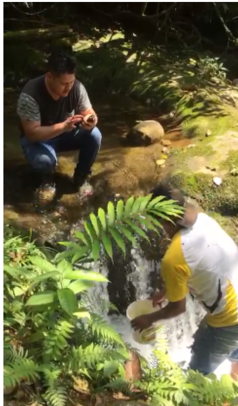
Figura 6: Mediciones de tiempo de llenado del recipiente en el primer punto. (Autores)
