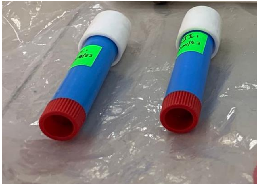
Fig.10: Tubos pasivos de medición de ozono.
