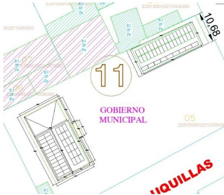
**Figura 15. Disposición física de los paneles solares monocristalinos en el área disponible**
