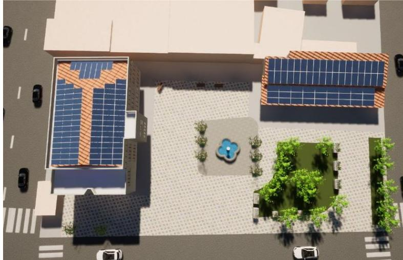
**Figura 18. Disposición de los paneles solares según PV\*SOL.**
