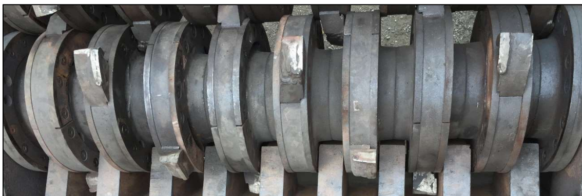
Figura 4.1 Ensamble de los rodillos, cuchillas y garras de arrastre.
